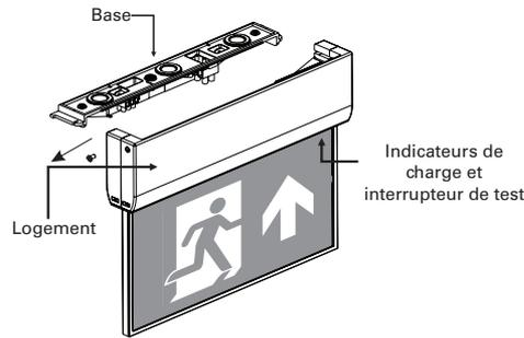
Retirez les vis des deux côtés de la lumière pour séparer la plaque de montage du luminaire.
